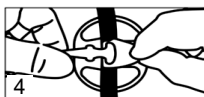
Издърпайте върха на лентата през отвора в устройството. Внимание: Не затягайте твърде много
