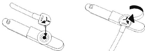
2. ábra: A táplálókészlet csatlakoztatása
