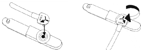
Figure 2 : Brancher le kit d'alimentation
