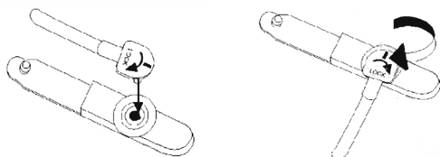
Abbildung 2: Anbringen des Einspeisesets
