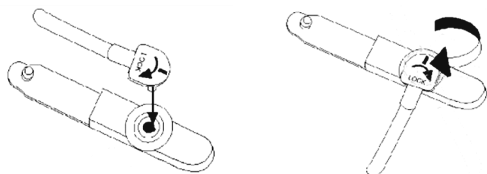
Slika 2: Pritrditev kompleta za hranjenje
