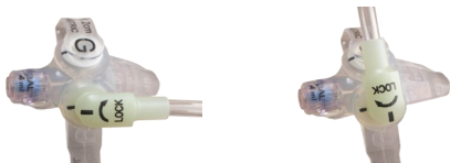
2. att. Glow Green pagarinājuma komplekta pievienošana
