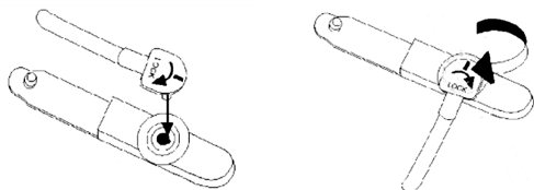
Abbildung 3: Anbringen des Einspeisesets
