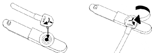
Figura 3: Attacco del kit di alimentazione
