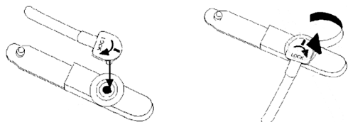
Figura 3: Fixação do conjunto de alimentação
