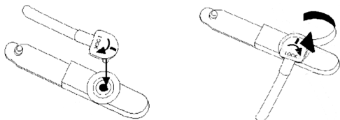
Figura 3: Colocación del conjunto de alimentación
